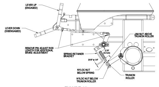
FIGURE 16 BRAKE ADJUSTMENT
